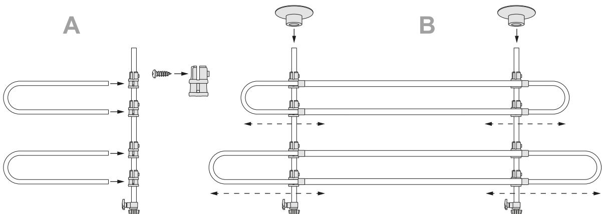
**C)** Draai de inbusbout in de voet van de staander tot deze 2 cm uitsteekt. Schuif daarna de rubber voet over de inbusbout.
