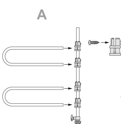
**B)** Schieben Sie die Teile der U-Halterung in die horizontalen Rohre. Passen Sie die Breite der gewünschten Größe an. Ziehen Sie nun die Klemmen fest. Dann schieben Sie die Gummistutzen über den Pfosten.
