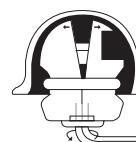
*Img. 3) Enfoncer la serrure cylindrique dans la boule (faire tourner la clé dans le sens inverse des aiguilles d'une montre). La sécurité antivol est mise en place.*
