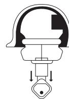
*Img. 2) Insérer la clé Allen dans l'orifice. Tourner vers la droite pour amplifier la boule et ainsi la fixer.*
